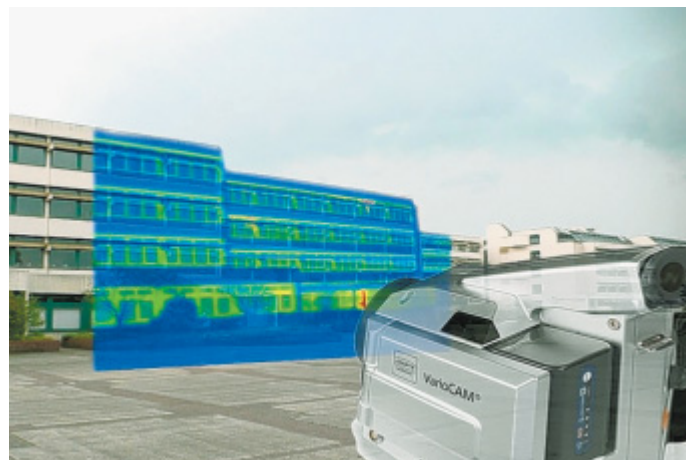
Die Gebäudeanalyse: Vor einer Sanierung werden mit einer Wärmebildkamera die Schwachstellen der Fassade aufgedeckt.
